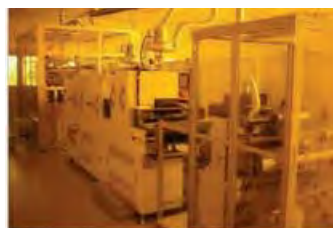
県内企業により試作された有機トランジスタ製作用印刷機
