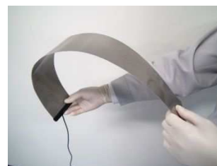
非拘束型センサシート(開発中) (文部科学省「地域イノベーション・エコシステム形成プログラム」(平成30年度採択))
