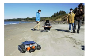
<海の自動クリーンロボット> 飛鳥の磯や海岸を自動飛行ドローンで撮影した画像解析と自走式ロボットにより効率的に回収
