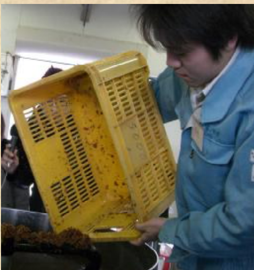
混合機へ搾りかすを投入
