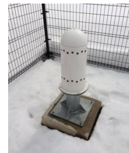
空間放射線量率を測定する ためのモニタリングポスト
