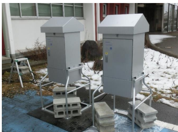
図1 重金属類の試料採取装置(ハイポリウムエアサンプラー)
