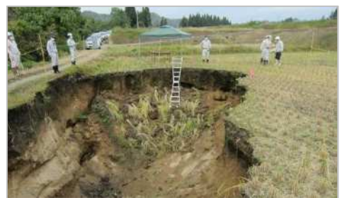
< 舟形町の亜炭採掘跡の陥没発生状況 >
