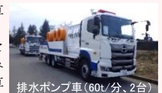
排水ポンプ車(60t/分、2台)
