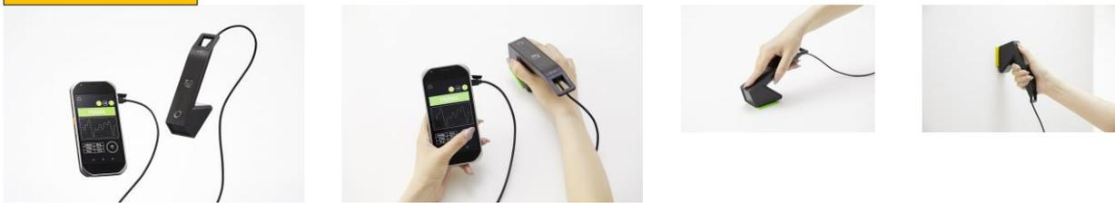
プラスチック材質判別装置「ぷらしる」は、近赤外線分光法による、ハンディタイプのプラスチック材質判別装置です。読取センサが内蔵されたセンサ部と、判別結果を表示するタブレットで構成されています。手ざわり・弾力・匂い・燃え方など、ベテランの経験則に依存しがちだった材質判別業務を「誰でも」「簡単に」「同じ基準で」行うことができます。
