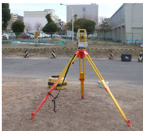
写真 - 7 TSの設置
