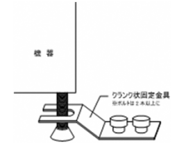
各種機械・設備の固定の例
