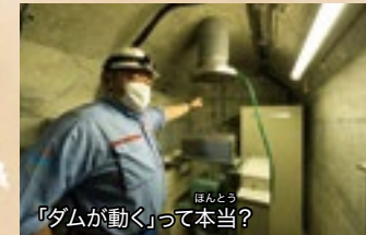
「ダムが動く」って本当? ダムは気温や貯水量などの影響で数ミリから1センチほど動くそう。その小さな動きを「プラムライン」という計器で測定し、ダムの安全性をチェックしています。
