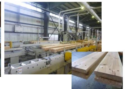
プレカットによる仕口加工
