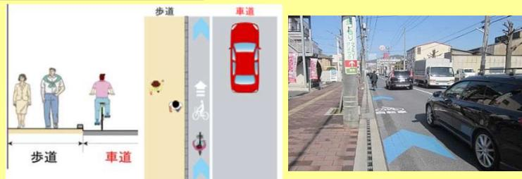
自転車と自動車が車道内で混在通行する、車道混在型で整備します。
