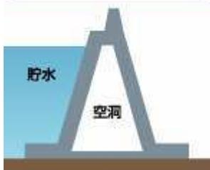
重力式コンクリートダムの内部を空洞にしたダムです。コンクリートの量は節約できますが、構造が複雑なので、現在では採用されていません。
