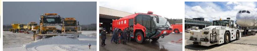
写真、Ⅲ-5-2 空港車両 (左より除雪車、化学消防車、トーイングトラクター)
