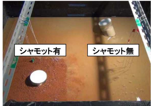
液状化の実験の写真 「シヤモット」は瓦を破碎したもの 出典：「あいち産業科学技術総合センター報道資料」（平成 25 年）
