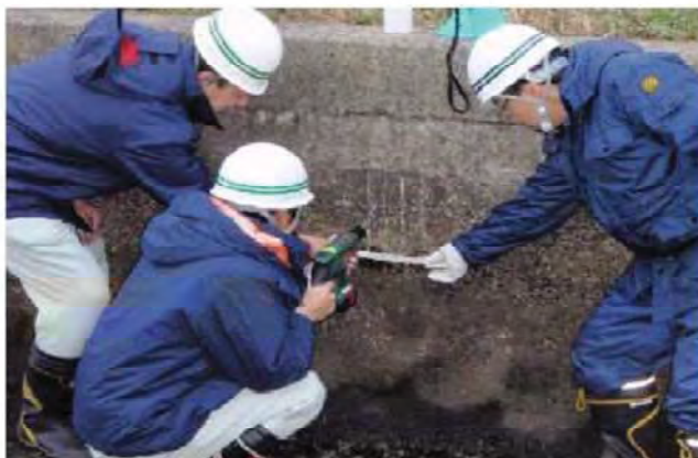
鉄筋探知機調査:コンクリートのかぶり厚と鉄筋の配置を調査
