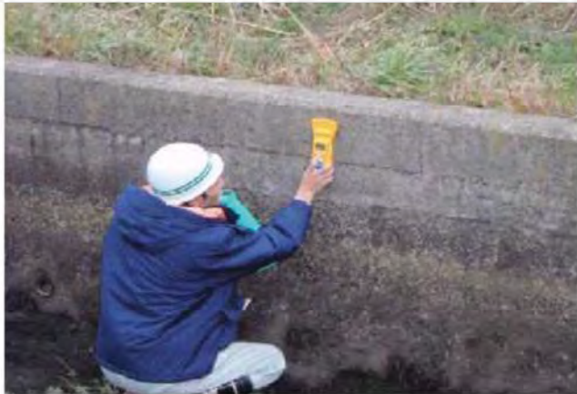
鉄筋探知機調査:コンクリートのかぶり厚と鉄筋の配置を調査
