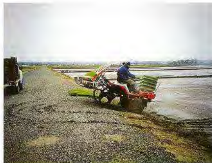
乗用田植機による農道ターン試験
